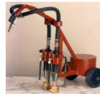
Bocciardatrice tipo "Rosso" per due martelli tipo "T" senza martelli, completa di gomma Bushhammering machine type "Rosso" for 2 type "T" without hammers, with hose
